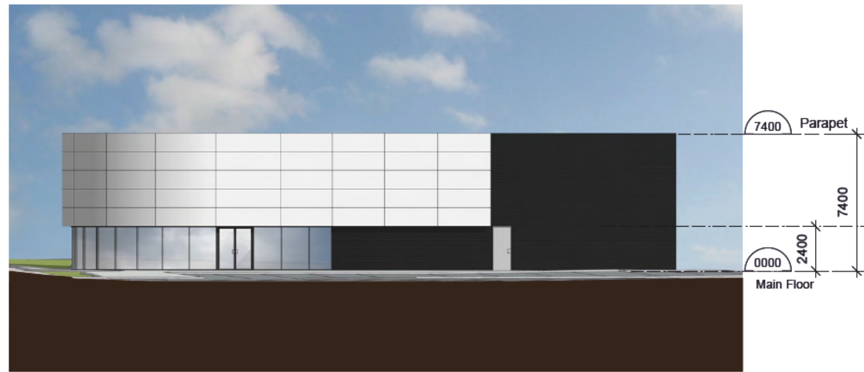
2 South Elevation - Building B scale: N.T.S.
